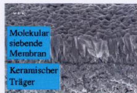
Molekularsiebe trennen Moleküle voneinander. Die neuartige keramische Membran trennt sogar Isomere, die die gleiche Anzahl Atome, aber eine unterschiedliche Struktur haben: schlankes n-Hexan (C 6 H 14 ) passt durch die Poren, sperriges Dimethylbutan (C 6 H 14 ) wird abgewiesen.
